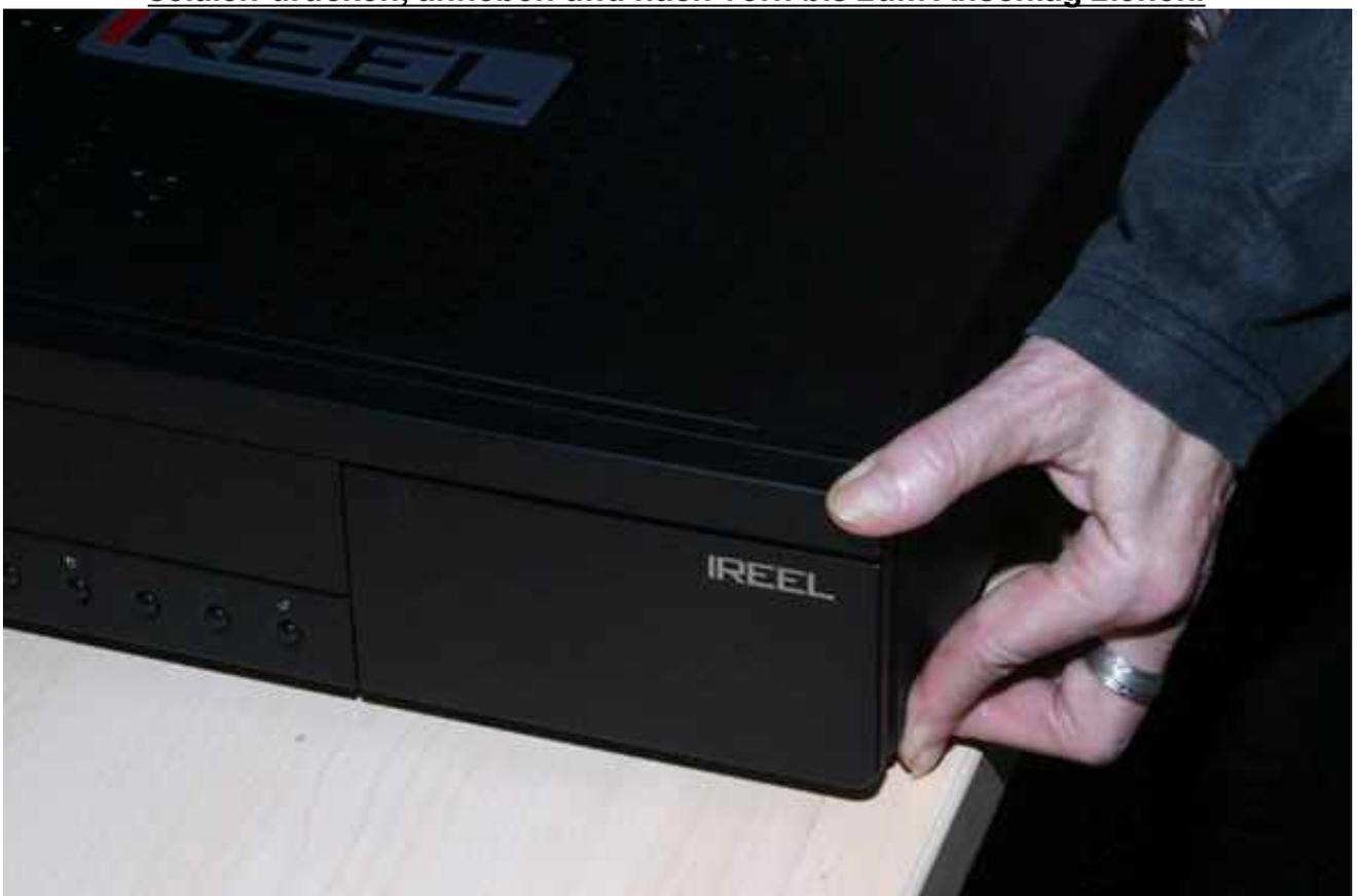
**und wieder anschrauben (zunächst alle fünf Rändelschrauben nur leicht einschrauben, erst wenn alle ihr Muttergewinde gefunden haben – festziehen)**
