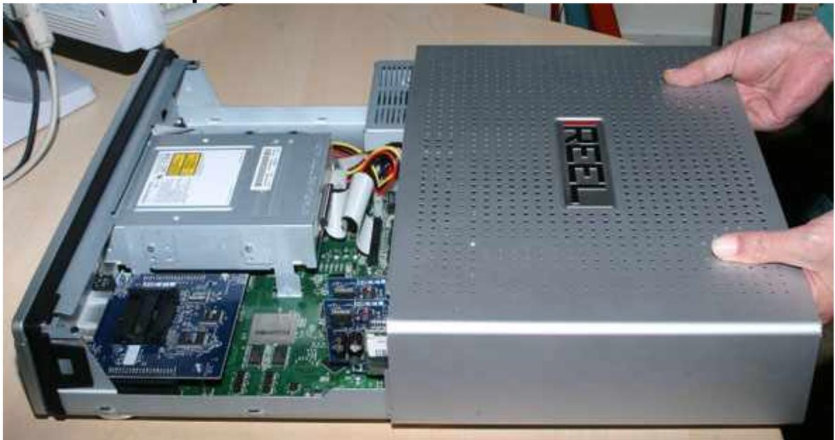
**4. Befestigungsschrauben Front lösen (2 Stück):**
