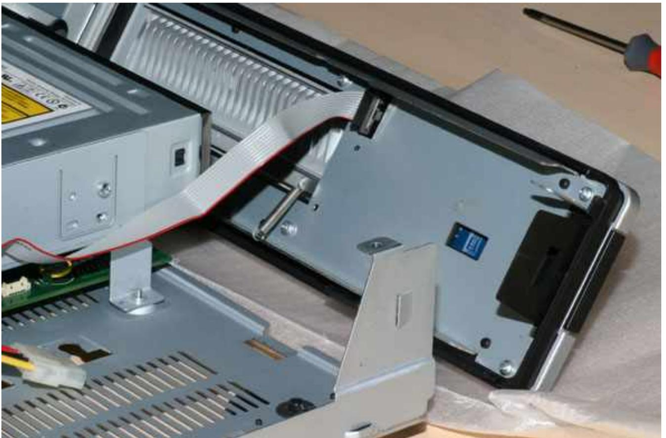
Position vom roten Index des Flachbandkabels am Frontblech markieren und Kabel ziehen; Front auf weicher Unterlage ablegen (Blech nach oben)
