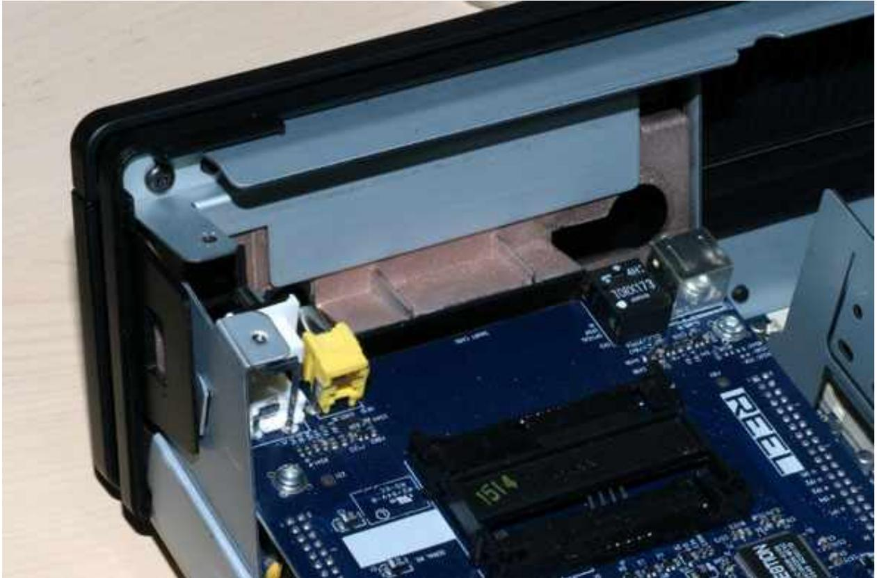
dann Front vorsichtig nach hinten kippen, bis diese senkrecht steht und die beiden Kunststoffflaschen in die Ausklinkungen vom Chassis einrasten.
