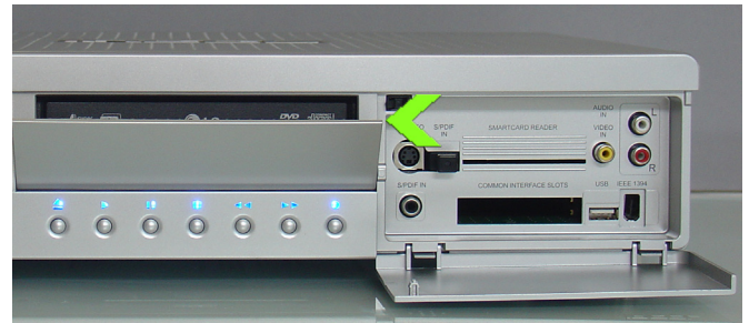
Bild 06: Herunterklappen der Laufwerksblende
