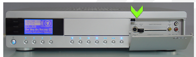
Bild 05: Öffnen der Abdeckklappe der Frontanschlüsse / CI-Slots
