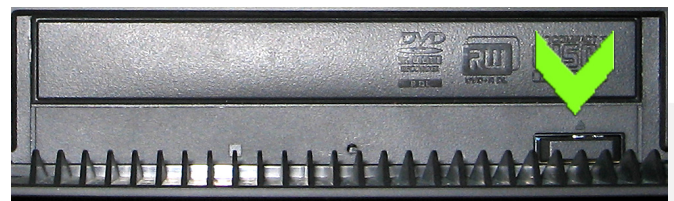
Bild 07: Drücken der Auswurf-taste am DVD-Laufwerk
